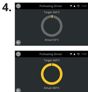
Во время предварительного прогрева на дисплее отображается последовательность нагрева камеры до заданного значения температуры.
