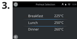
Если в печи установлены две или большее количество значений температуры предварительного прогрева, отображаются варианты выбора.
